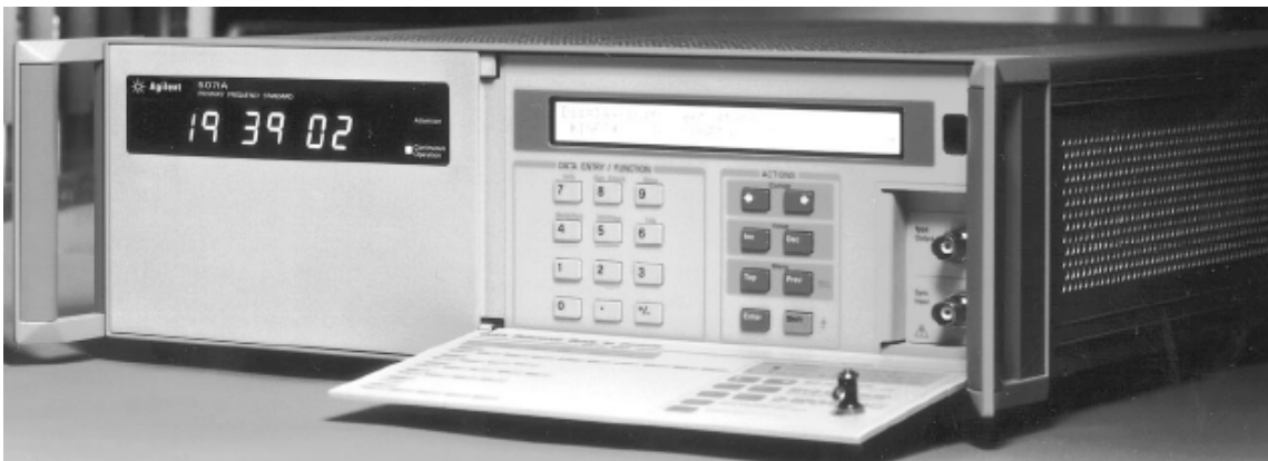
Un moderno orologio a cesio (Agilent 5071A)
