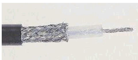
Figure 1.9: Un cavo coassiale RG58/CU, con conduttori in rame stagnato, isolato con polietilene (PET) e con guaina esterna in polivinilcloruro (PVC) nero.
