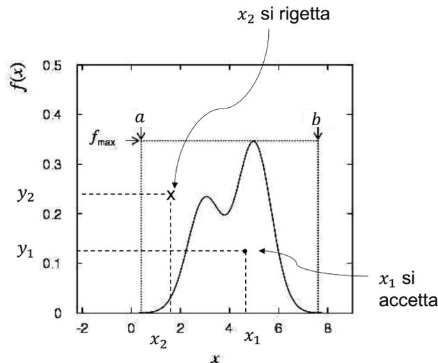
Figure 1: Illustrazione del metodo accept-reject. Il punto  $x_1$  si accetta mentre  $x_2$  si rigetta.
