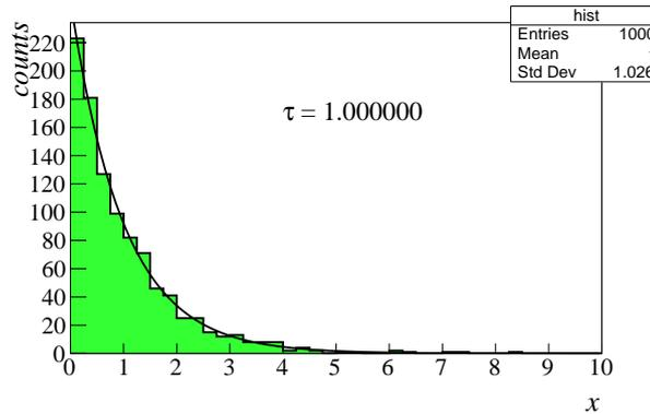
Figure 3: Esempio di generazione di 1000 numeri casuali con funzione di distribuzione esponenziale con  $\tau = 1$ , usando il metodo accept reject. La curva rappresenta il numero di conteggi atteso in ciascun intervallo dell'istogramma.
