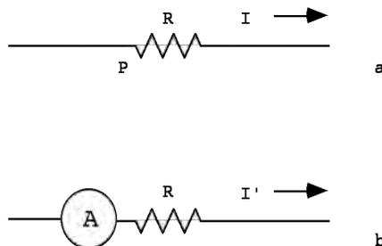
Se l'amperometro è uno strumento ad ago la corrente deve entrare nel morsetto positivo e uscire da quello negativo, mentre se la scala è numerica, il verso in cui passa la corrente viene semplicemente indicato da un segno + o - sul visore.
