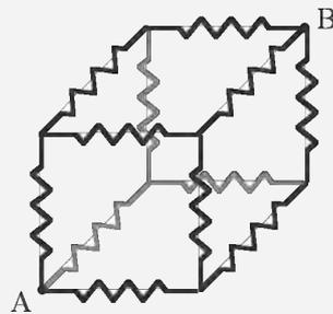
Le resistenze sono disposte lungo i lati di un cubo: si trovi la resistenza equivalente tra i due vertici A e B.
