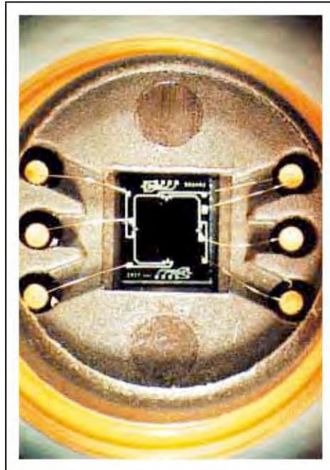
Nel diagramma elettrico di questo sensore è facile individuare il ponte di Wheatstone che costituisce la parte sensibile
