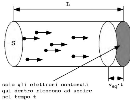
Quando facciamo passare corrente nel conduttore c'è un campo elettrico che trascina gli elettroni, li fa entrare ad una estremità del conduttore e li fa uscire all'altra estremità. In un dato tempo  $t$  gli elettroni percorrono la distanza  $v_d \cdot t$ , per cui escono dal conduttore tutti quelli che sono a distanza minore o uguale a  $v_d \cdot t$  dall'estremità di uscita.
