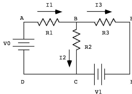
in questo circuito si possono individuare 3 maglie, quelle costituite dai circuiti ABCD, ABEFCD e BEFC, ci sono 7 rami, 6 nodi (dove per nodo si intende genericamente un punto dove si incontrano 2 o più rami) e 2 nodi in senso proprio, dove si incontrano tre rami. Questo circuito può essere associato ad un grafo come quello mostrato qui sotto
