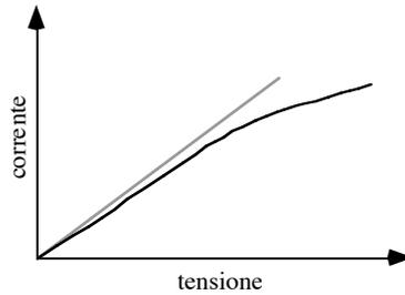
Il filo metallico della lampadina si comporta come quella di una normale resistenza alle basse temperature (quando la lampadina non è ancora incandescente) e poi inizia a curvare (curva nera nella figura sopra). In un caso come questo non si può definire una resistenza, ma si possono invece dare la resistenza media e soprattutto la resistenza dinamica, che è data da
