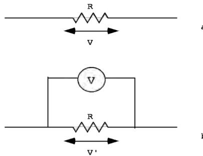
Anche il voltmetro, come l'amperometro, ha una certa resistenza interna  $R_V$ , e come l'amperometro anche il voltmetro altera con il suo inserimento il circuito che si sta studiando.
