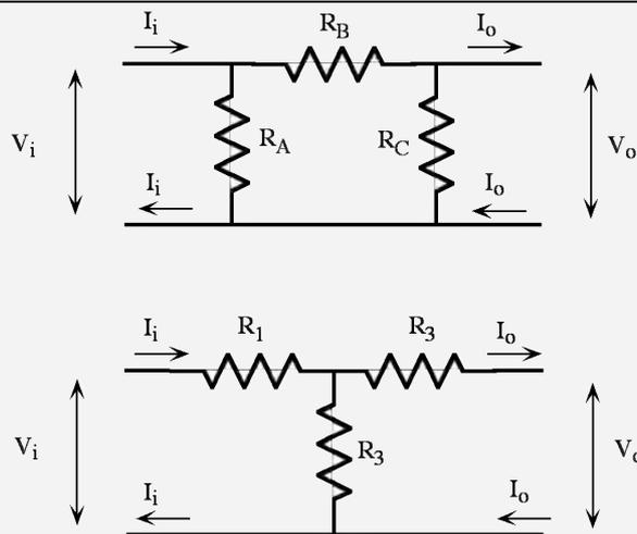
Si trovi la relazione tra  $R_A$ ,  $R_B$ ,  $R_C$  e  $R_1$ ,  $R_2$ ,  $R_3$  in modo che i due circuiti si comportino nello stesso modo (le tensioni e le correnti d'ingresso/uscita devono essere le stesse, in modo che un generatore o un utilizzatore esterno non possa accorgersi che i circuiti sono differenti...).
