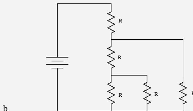
Chiamiamo  $R(1)$  la resistenza equivalente nel caso a. e  $R(2)$  la resistenza equivalente nel caso b. Come si può generalizzare il circuito? Se  $R(n)$  è la resistenza equivalente dell' $n$ -esimo circuito, come si scrive  $R(n+1)$  in funzione di  $R(n)$ ? Qual è il valore limite di  $R(n)$  per  $n$  che tende all'infinito?
