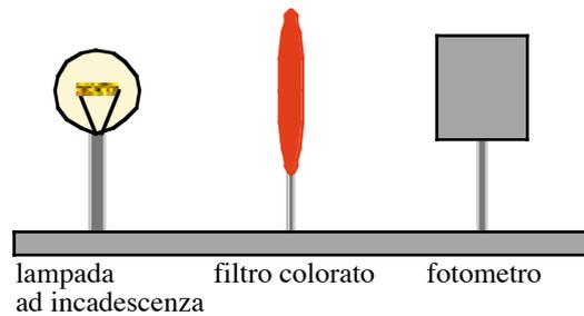
la lampada ad incandescenza va alimentata dal generatore, ed inoltre il circuito della lampada deve comprendere anche un voltmetro (in parallelo alla lampada) e l'amperometro (in serie), in modo da misurare la tensione  $v$  ai capi della lampada e la corrente  $i$  nel circuito e calcolare quindi la potenza  $W = vi$  dissipata dalla lampada.
