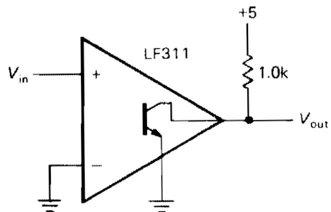
L' esempio più semplice di comparatore: un amplificatore differenziale ad alto guadagno (V<sub>out</sub> corrisponde alla tensione di saturazione =  $\pm V_{\text{cc}}$ )
