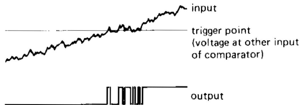
Comparatore con una rete di input che definisce il valore della tensione di soglia: in questo caso il rumore in prossimità della soglia rende instabile il passaggio dallo stato basso allo stato alto.
