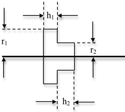
Una puleggia è costituita da due cilindri coassiali, il primo di raggio  $r_1 = 5$  cm e altezza  $h_1 = 2.5$  cm ed il secondo di raggio  $r_2 = 2$  cm ed altezza  $h_2 = 3$  cm, entrambi costituiti di ferro (densità  $7.8$  g/cm<sup>3</sup>). La puleggia ruota attorno al suo asse, compiendo 450 giri/min.
